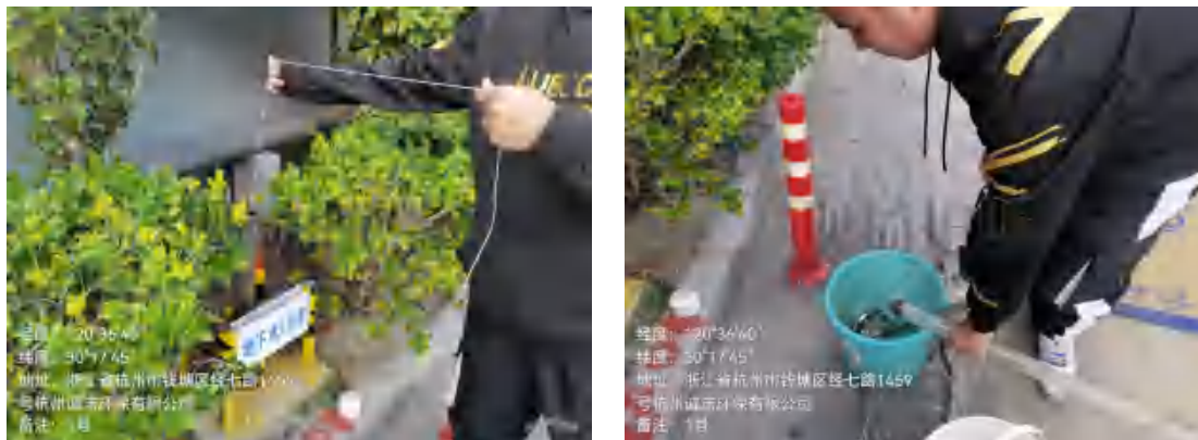
图7.2-6 采样前洗井照片
