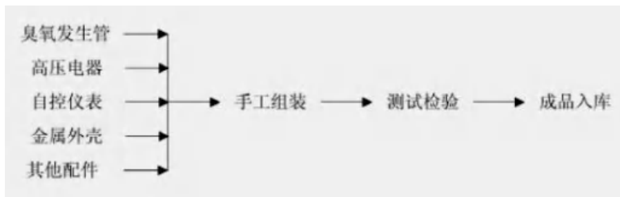
图 4.1-7 臭氧技术处理设备生产工艺流程图
